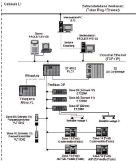
Anlagenkonfiguration der Doppelbatch-Anlage
